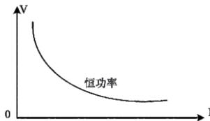
图 5-4 CP 模式电压电流关系图
