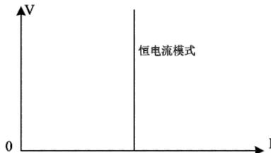
图 5-1 CC 模式电压电流关系图
