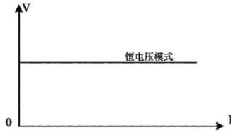
图 5-2 CV 模式电压电流关系图
