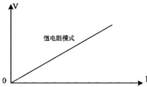
图 5-3 CR 模式电压电流关系图
